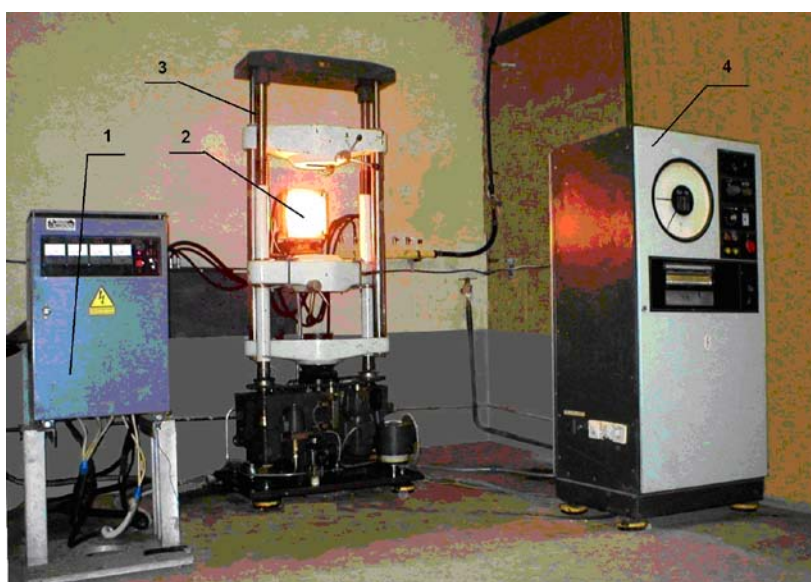
Рисунок 1. Общий вид испытательного стенда: 1 – преобразователь напряжения; 2 – система нагрева; 3 – разрывная машина; 4 – пульт управления.
