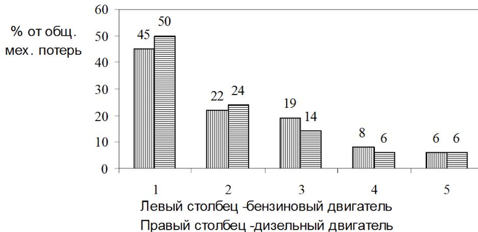
Рис.1.8. Распределение составляющих механических потерь по узлам и агрегатам ДВС: 1 – ЦПГ; 2 – КШМ; 3 – газообмен; 4 – ГРМ; 5 – навесные агрегаты
