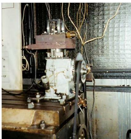
Рис.5.2. Общий вид поршневого трибометра согласно [103]
