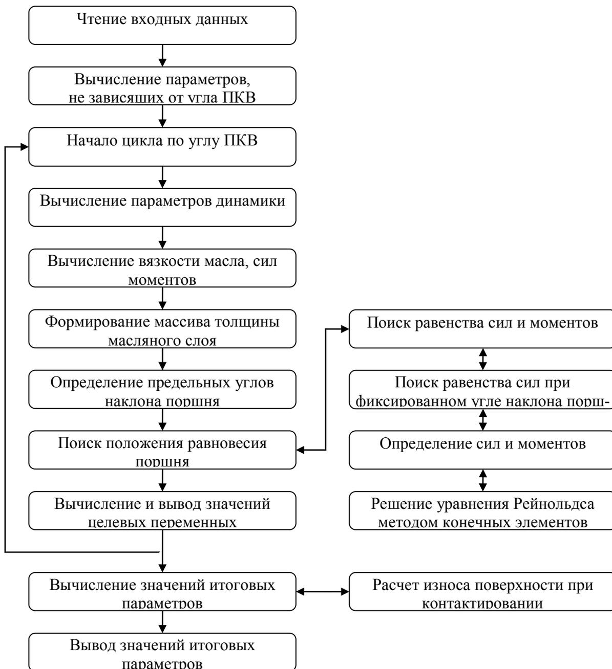
Рис.3.4. Последовательность логических и вычислительных процедур программы PISTON
