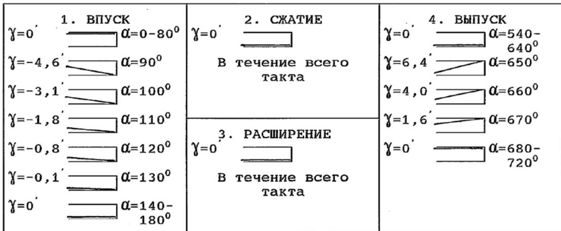
Рис.3.19. Результаты расчета осевой перекладки и скручивания первого компрессионного кольца в канавке поршня дизеля 4Ч10,5/12
