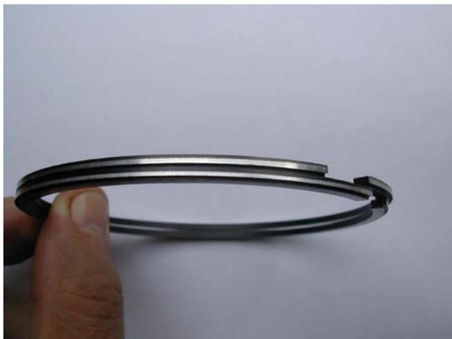
Рис.6.36. Вид рабочей поверхности отработавших 20ч компрессионных конических поршневых колец дизеля ТМЗ-450Д: сверху кольцо, отработавшее на масле М-10ДМ; снизу – на масле М-10ДМ+3% ТС ММ
