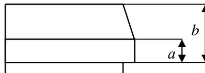
Рис.6.33. Эскиз к определению относительного износа рабочей поверхности 2-го поршневого компрессионного конического кольца
