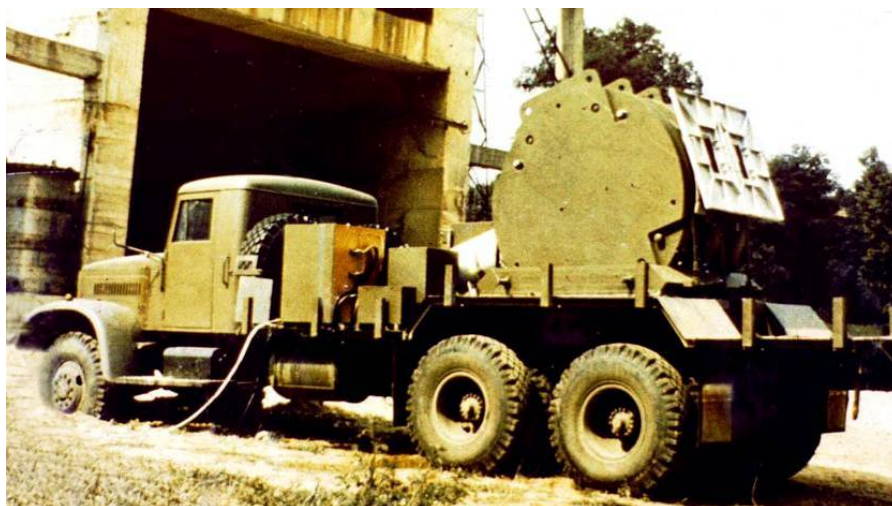
Рисунок 43 - Мобильный импульсный МГД-генератор «Прикаспий» электрической мощностью до 10 МВт
