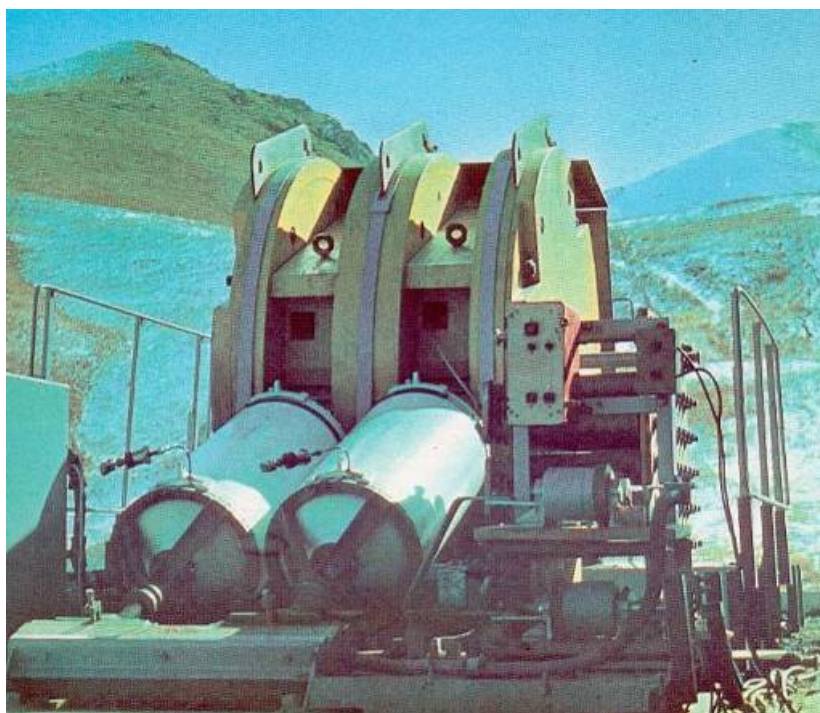
Рисунок 23 - Двухканальная импульсная МГД-установка с четырьмя неохлаждаемыми медными катушками
