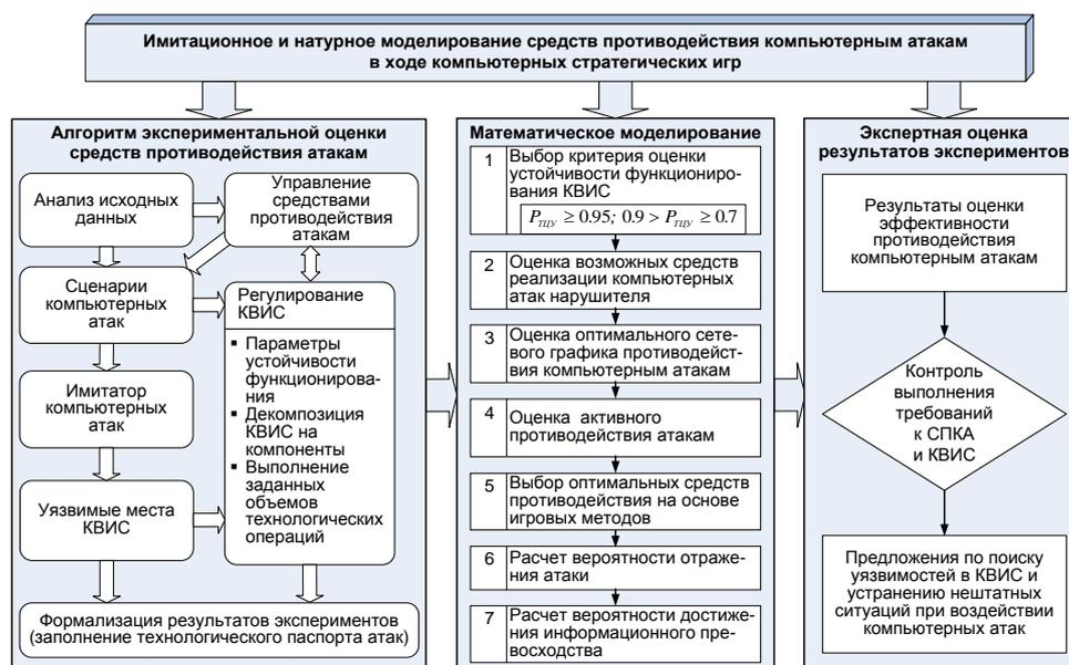
**Рисунок 30 – Порядок экспериментальной оценки средств противодействия компьютерным атакам на стендовом полигоне**
