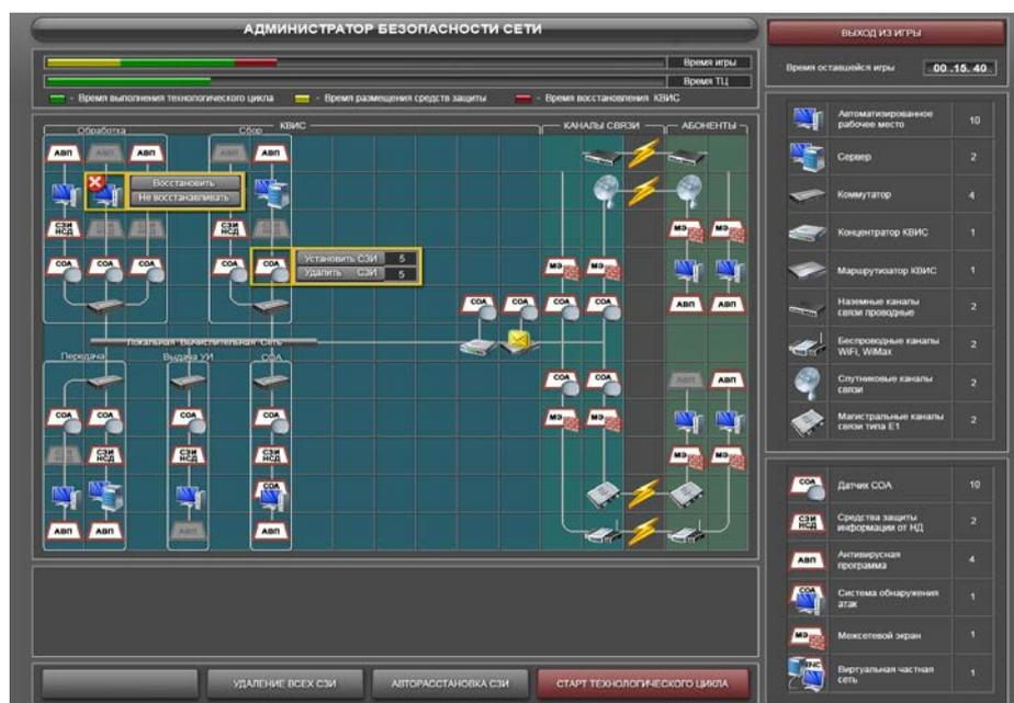
**Рисунок 27 – Интерфейс противодействия компьютерным атакам на основе применения комплекса СЗИ**
