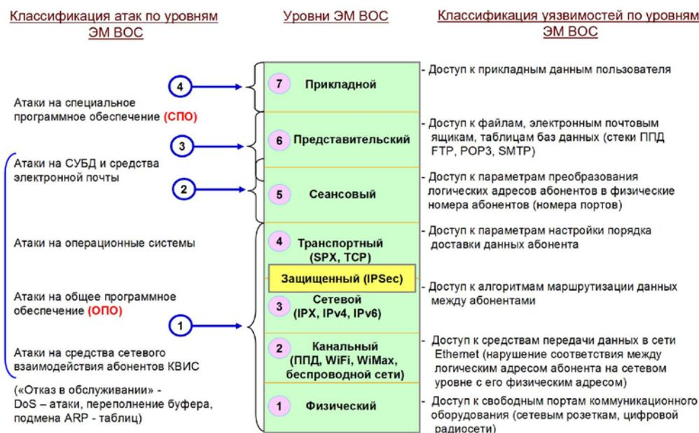
Рисунок 5 – Уязвимости КВИС на базе протокола ТСР/ІР
