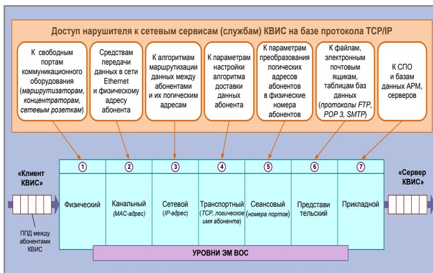
**Рисунок 7 – Модель уязвимых мест КВИС на базе ЭМ ВОС**
